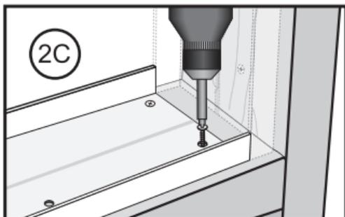
Nota: Cortar el canal superior a la mitad permitirá la instalación de la hilera superior de bloques. Si un panel solo tiene el ancho de uno o dos bloques, el canal lateral también se deberá cortar a la mitad.
