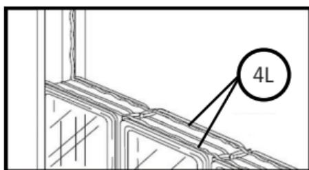
M. Coloque un espaciador horizontal sobre la parte superior de la primera fila de bloques. Si se requiere más de una sección de espaciador horizontal, asegúrese de que queden planas de extremo a extremo con la junta directamente arriba de un espaciador vertical. Alterne estas juntas en cada hilera siguiente.
