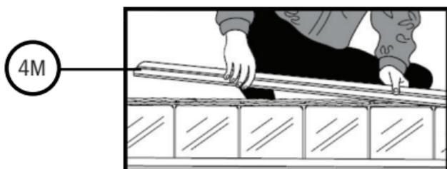
N. Limpie el exceso de sellador. Si es necesario, ajuste el tamaño de los cordones de sellador para evitar la salida del sellador en las siguientes hileras. Las áreas de las juntas deben estar libres de sellador.
