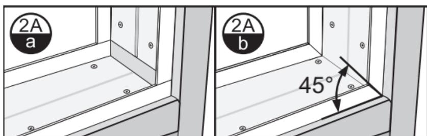
B. Corta el Canal Superior por la mitad a lo largo con un cuchillo. Marque la ranura central con el cuchillo y rompa el canal por la mitad. Aplique sellador de bloques de vidrio en la parte posterior del canal antes de instalar.
